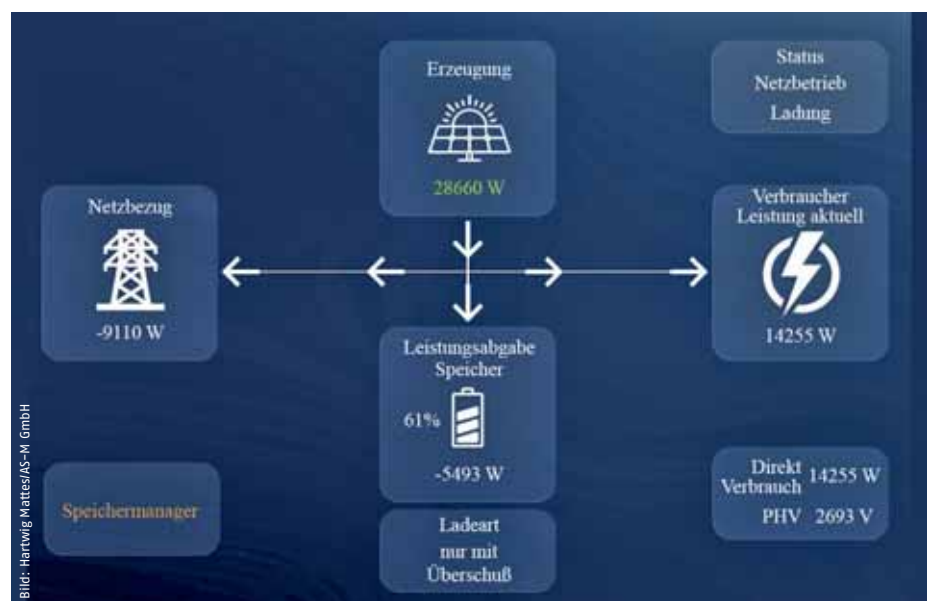
Der Blick auf die Oberfläche der Smart-Home-Steuerung zeigt, wie viel Strom produziert, gespeichert oder vom Netz bezogen wird.
