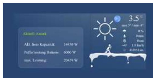
Bild 6: Blick auf die Oberfläche der Smarthome-Steuerung: In die Planung, wie groß die Stromreserve sein muss, wird sogar die Wetterprognose mit einbezogen
