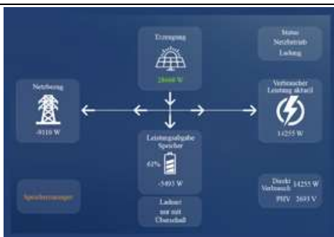
Bild 5: Der Blick auf die Oberfläche der Smarthome-Steuerung zeigt jederzeit, wie viel Strom produziert, gespeichert, vom Netz bezogen wird usw.
