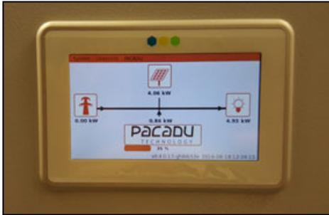
**Bild 3:** Das Display des Pacadu-gesteuerten Speichers: Von den knapp 5 kW, die gerade verbraucht werden, kommen 4 kW aus der PV-Anlage, knapp ein 1 kW vom Stromspeicher – und 0 kW vom öffentlichen Netz
